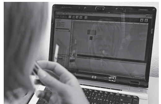
Fig. 7: les écrans brillants ne sont pas adaptés, car ils produisent des reflets désagréables.
