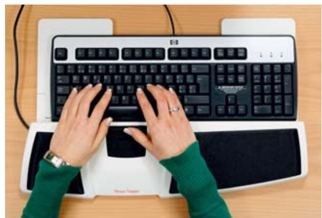
Fig. 17: Cette souris spéciale placée devant le clavier s'utilise avec les deux pouces.
